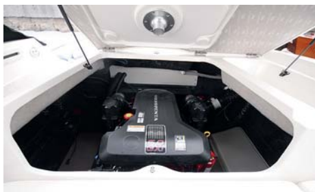
Člun je poháněn motorem Volvo Penta 5.0 GXi o výkonu 270 koní s dualpropelerem.
