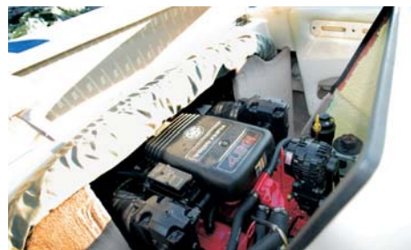
Šestiválec Volvo Penta 4,3 GL se skrývá pod zadní sedačkou stejně jako bimini.
